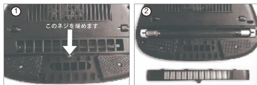
注意: 殺菌モードがオンになっている時にUV殺菌のLEDインジケータのライトが点灯しない場合は、UVライトの溝の内側にある光センサーの開口部がホコリで塞がれていないかチェックしてください。塞がれている場合は、ブラシでクリーニングしてください。
